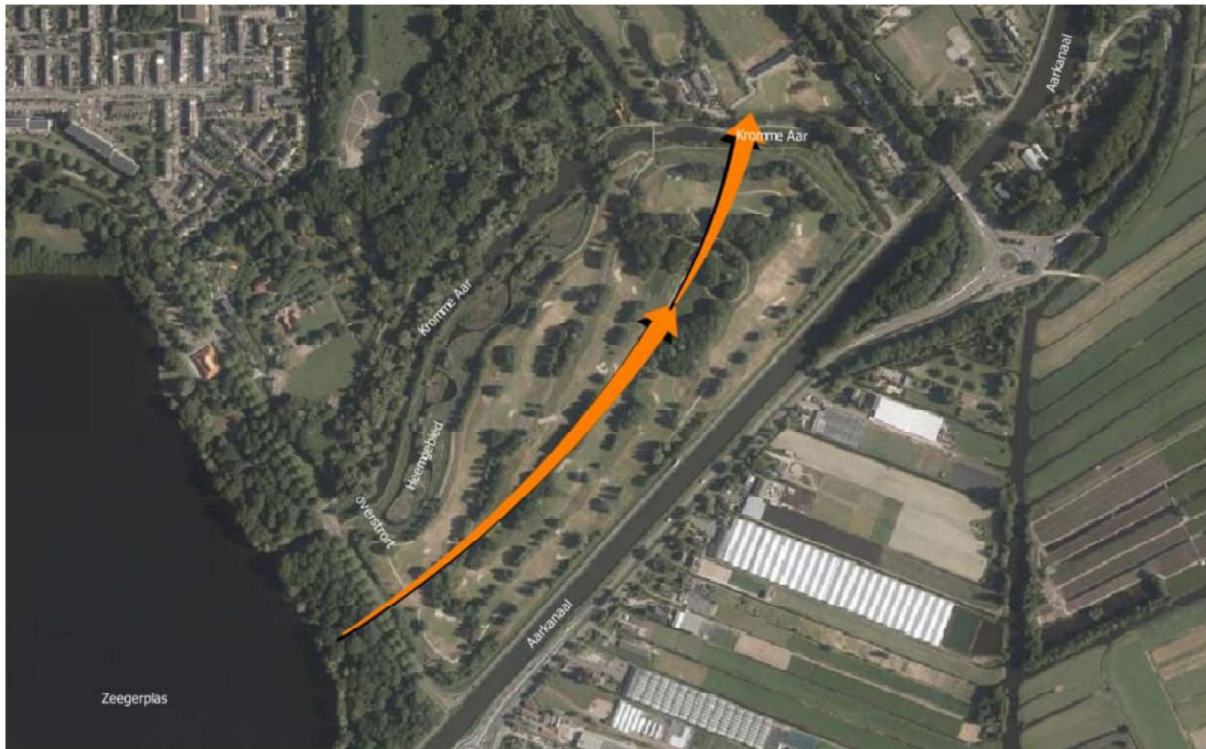
Figuur 5.4: globale stromingsrichting eerste watervoerend pakket
